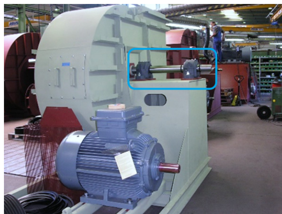
Esempio di applicazione con cuscinetti del rotore di un ventilatore industriale.
